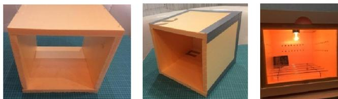
Температуру регулируем с помощью диммера, влажность – с помощью воды. После того как в инкубаторе температура и влажность стала соответствовать заданным значениям, приступаем к закладке яиц.
